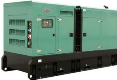
鼎新公司低噪音系列发电机组，按功能可分为防雨型和静音型；采用声学、气流学领域的先进技术，经过合理开发设计，可将噪音降低至68dB(a)-85Db(a)（机组运行时,距离7米处测试噪声）；设计理念先进，规格型号齐全，产品除具备柴油发电机组各项基本功能外，还具备噪音低，结构紧凑，箱体全部采用可拆卸式钢板拼接而成，箱体表面经过高性能防锈漆保护处理，同时具备防雨、防尘和降噪功能，箱体内部采用多层次屏障错配式消声结构，内置式消音器，箱体内部配备有大容量底座油箱左右设有两道检修门，以便机组故障检修和日常维护保养，同时在箱体上开有观察窗和机组紧急停机故障按钮，以便观察机组的运行情况以及机组出现紧急情况时，以最快的速度停机，确保机组不受到损坏。
