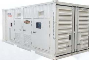
鼎新公司集装箱型电站系列有标准型和静音型，均采用标准20英尺和40英尺两种规格集装箱依照国际标准集装箱改造设计，该设计保证机组在运输过程中不会由于限高损坏，并且外形美观，结构紧凑，便于吊装、运输、流动使用，由于采用高强度的箱体和尺寸标准化的设计，大大地节约用户运输成本，静音型箱体内部配备有高性能耐老化阻燃隔音材料和吸音材料，同时箱体设计更加人性化，箱体外两侧均有检修门，可预留操作、维修和值班工作室，箱体内可置8小时日用油箱。
